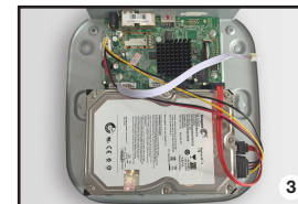
Umístěte disk HDD do rekordéru dle ploch pro uchycení. Kabeláž umístěte kolem disku HDD.
