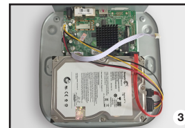
Umiestnite disk HDD do rekordéru podľa plôch pre uchytienie. Kabeláž umiestnite okolo disku HDD.
