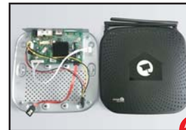
Odłącz urządzenie NVR od zasilania, odkręć i usuń górną obudowę.
