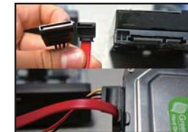
Podłącz kable zasilania i danych SATA z urządzenia NVR do odpowiednich portów na dysku twardym (jak pokazano).
