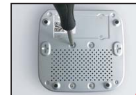
Trzymając dysk twardego i NVR, delikatnie go obróć, wyrównaj otwory na dysku twardym z otworami na NVR. Używając śrubokrętu Phillips, przykręć dostarczonymi wkrętami. Załóż pokrywę.
